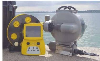
Geschützt im Gehäuse befindet sich eine integrierte um 270° drehbare, lichtstarke HD-Kamera (Live-Bilder werden direkt auf den Bildschirm an der Fernbedienung übertragen). Zur Dokumentation kann ein Videoaufzeichnungsgerät angeschlossen werden.
